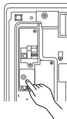
При каждом нажатии E.O.SW режимы работы переключаются в следующем порядке:
