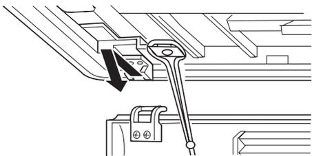
4. Устанавливайте переднюю панель, выполняя инструкции по ее снятию в обратном порядке. Надежно закройте переднюю панель и нажмите на области, указанные стрелками.
